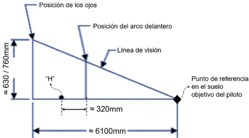
El vehículo tiene que estar equipado con **dos retrovisores**, uno a cada lado del vehículo en posición simétrica a la línea longitudinal del monoplaza. La posición de los retrovisores ha de ser tal que el piloto tenga una visión clara de ellos, sin tener que modificar la posición de conducción y que le permita tener una visión hacia atrás sin obstrucciones.
