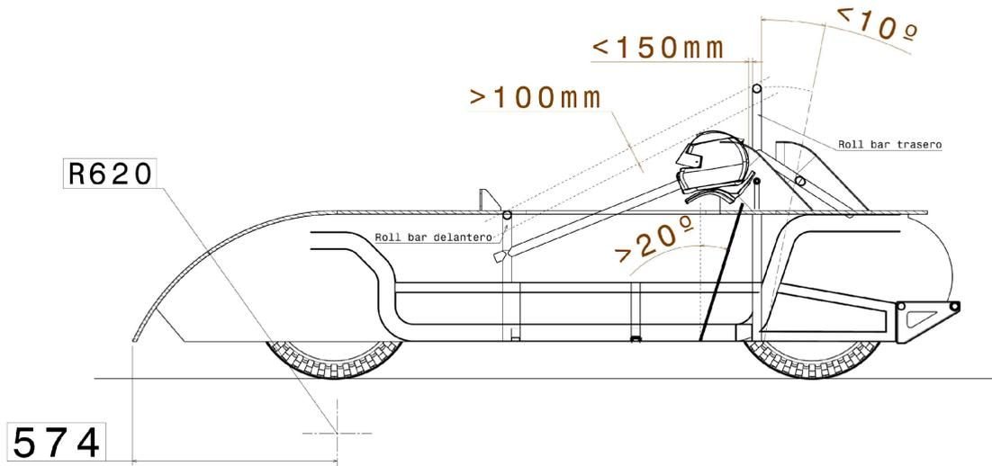
El roll bar se podrá instalar soldado al chasis o atornillado. Los tornillos utilizados deben ser en todo caso **M8** o superior y de **calidad 8.8** o superior. El arco delantero y el trasero deben estar unidos por una estructura suficientemente resistente como para que, en caso de accidente, el compartimento del piloto quede inalterado.
