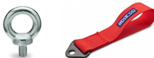
En caso de que la argolla sobresalga del frontal del vehículo y pueda suponer un peligro, se deberá desmontar para la realización de las pruebas dinámicas. La argolla deberá permanecer en el box prepara para usarse en caso de que sea necesario.
