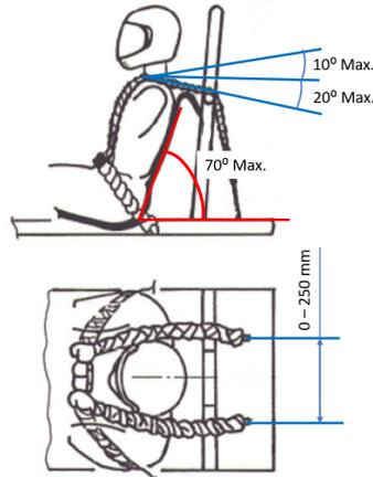
El arnés de seguridad siempre se debe usar apretado y bloqueado, para evitar que el conductor tenga libre circulación cuando el vehículo está en movimiento.
